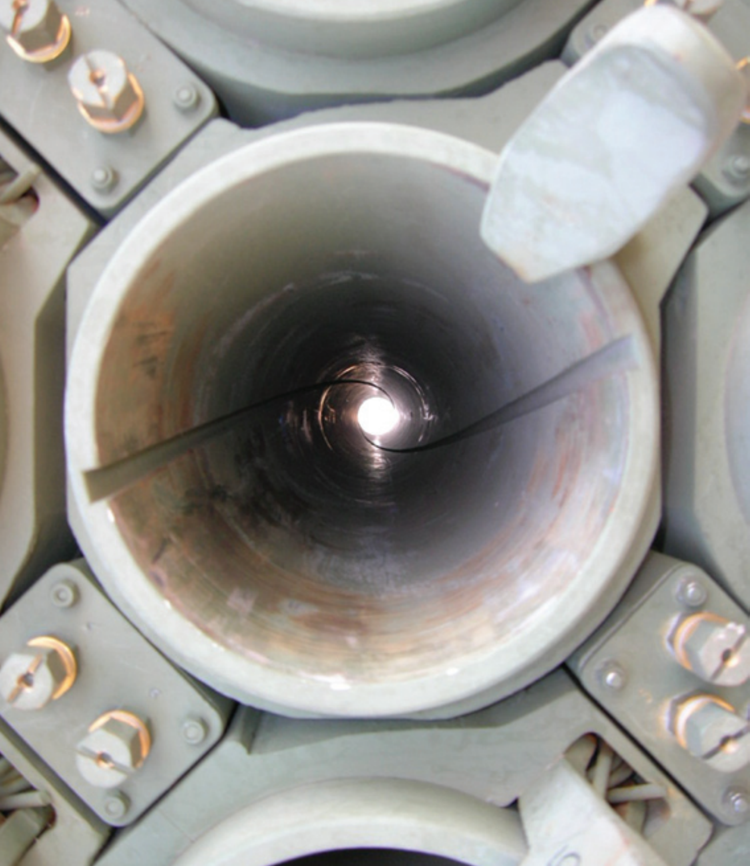
▲ CP 30: Tubo lanzador de los módulos con base de conexión de cohetes
