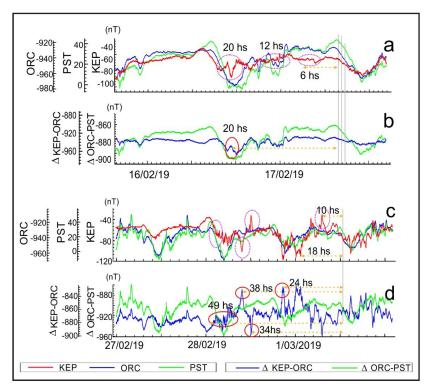
El análisis del espectro de frecuencias obtenido al aplicar wavelets a los deltas  $\Delta$ KEP-ORC y  $\Delta$ ORC-PST al período correspondiente del 15/2/2019 al 17/2/2019, el equivalente a  $\sim$  48 horas antes que se produjeran los sismos del 17/2/2019
